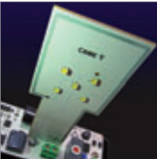
Wbudowana antena poprawia skuteczne zasięgi pilotów.
