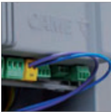
Wejście BUS obsługujące technologię CAME CXN BUS.
