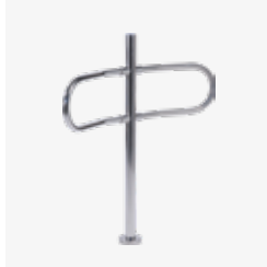
001PSOPG01 Barierka rozdzielająca ruch pieszych, wyposażona w słupek z łukiem ze stali AISI 304, dolną rozetę montażową ze stali ocynkowanej przykrytą deklek z chromowanego plastiku. H = 1000 mm.
