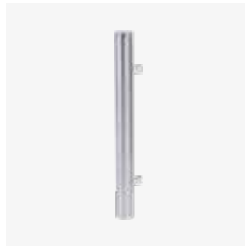
001PSTRV80 Staander van AISI 304 staal. H = 900 mm, Ø 80 mm. Verkrijgbaar zonder klemmen, met 2 klemmen, met 2+2 klemmen op 90° of 180°, met 6 klemmen, met 8 klemmen.
